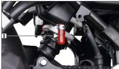
(1) Tubo de drenaje
