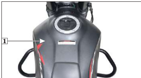
(1) Tanque de combustible
