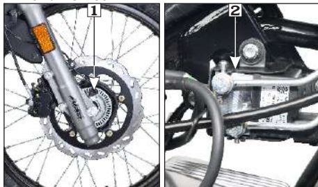
(1) Sensor de velocidad de la rueda (2) Unidad de control electrónico hidráulico (HECU)
