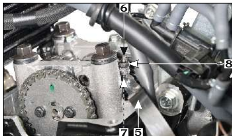
(5) Medidor de espesores (6) Tornillo de ajuste (7) Vástago de la válvula (8) Tuerca bloqueo
