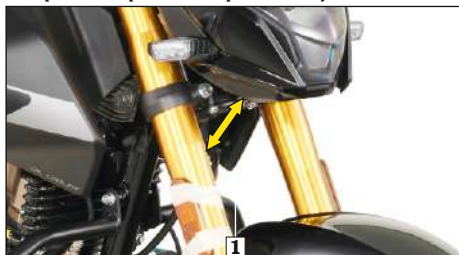
(1) Perno de ajuste de la luz principal
