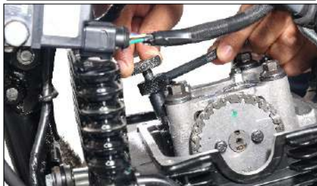
(5) Medidor de espesores (6) Tornillo de ajuste (7) Vástago de la válvula (8) Tuerca bloqueo
