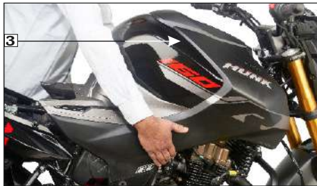
(3) Cubierta del tanque de combustible
