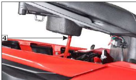
(4) Tubo de drenaje
