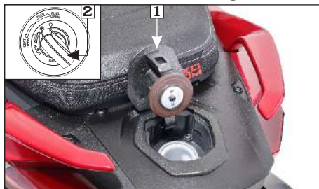
(1) Tapa del depósito de combustible
